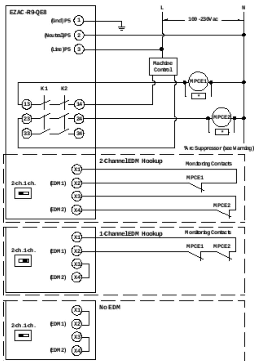
Figure 8. Wiring—model EZAC-R11-QE8
