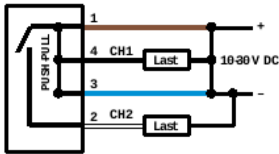
Abbildung 10. Kanal 2 als PNP-Schaltausgang oder als PFM-Ausgang
