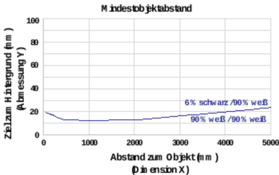
Abbildung 21. Mindestobjektstand für eine Ansprechgeschwindigkeit 250 ms
