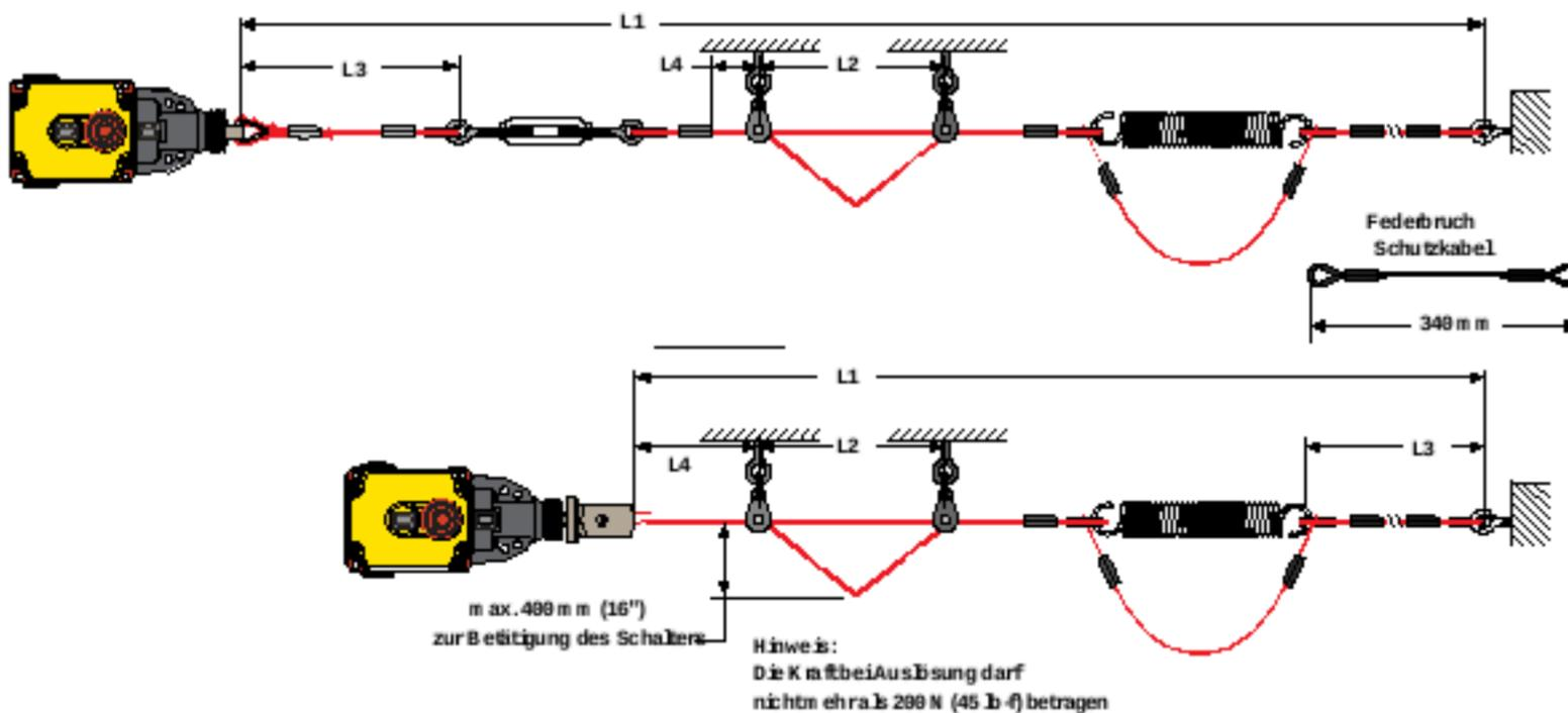
Abbildung 4. Montage von Seil und Befestigungszubehör
