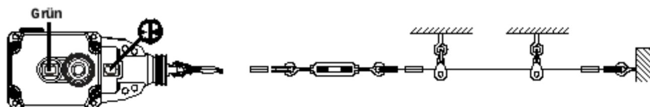
Abbildung 1. RUN-Zustand (korrekte Seilspannung) – Kontakte 11/12 geschlossen
