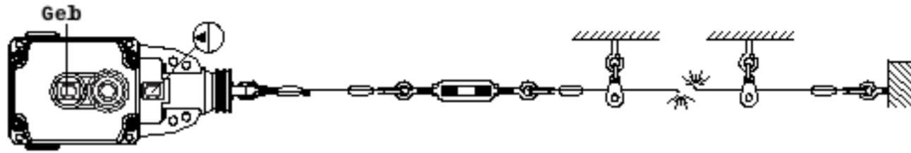
Abbildung 3. Seilbruch-Zustand – Kontakte 11/12 geöffnet
