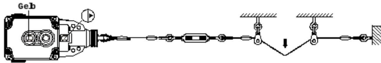
Abbildung 2. Seilzug-Zustand – Kontakte 11/12 geöffnet
