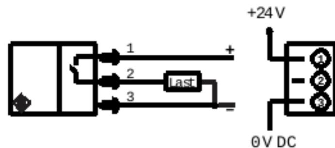
Abbildung 11. Elektrische Anschlüsse für Warnsignal
