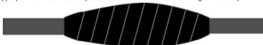
Étape 3 : protégez le chatterton des dommages causés par les UV en lui superposant une couche de ruban isolant. Le ruban isolant doit entièrement couvrir le chatterton et dépasser de 2,5 cm de chaque extrémité du connecteur.
