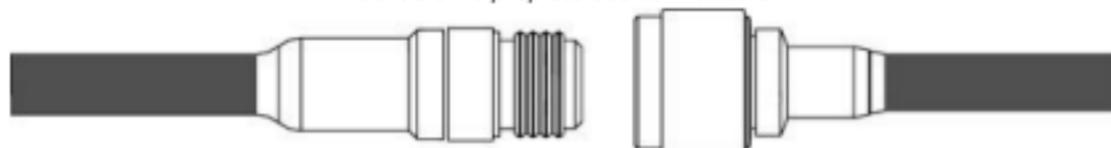
Étape 1 : assurez-vous que les connecteurs sont propres et essuyez-les avant de brancher le câble d'antenne à l'antenne ou à un autre câble. Ensuite, serrez à la main les câbles de raccordement.
