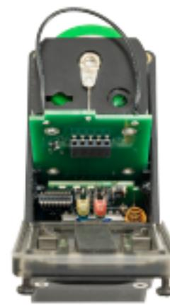
1. Afloje la placa de sujeción con un pequeño destornillador Phillips y levante la cubierta.
