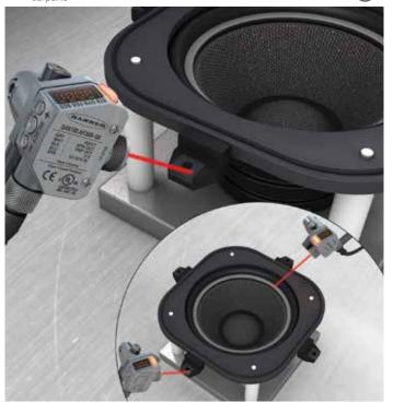
O Q4X verifica a presença de um único espaçador enquanto também monitora a intensidade para verificar que o lado com adesivo está para baixo. Modo de máster/escravo fornece prevenção de interferência quando se utilizam vários sensores próximos uns aos outros.
