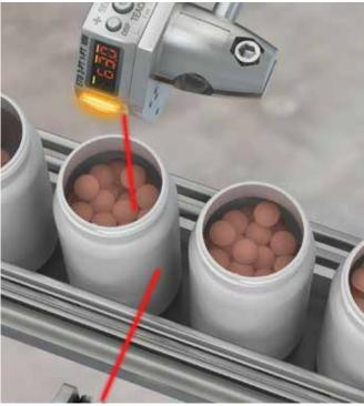
O sensor analógico Q4X utiliza o seu modo de disparo com média para fornecer uma medição de nível de enchimento mais consistente em superfícies irregulares, como pílulas dentro de um frasco.
