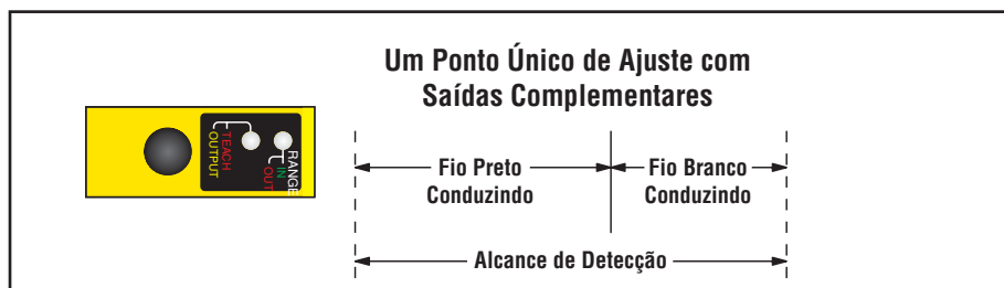
Figura 7. Programando limites de ponto de ajuste de detecção separados, saídas complementares
