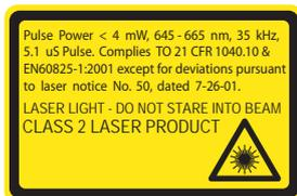
Potência de saída de pulso <4 mW, 645 - 665 nm, 35 kHz, 5,1 mS pulso. De acordo com 21 CFR 1.040,10 e EN60825-1: 2001, exceto para desvios relacionados à laser notice No. 50, datada de 7-26-01.
