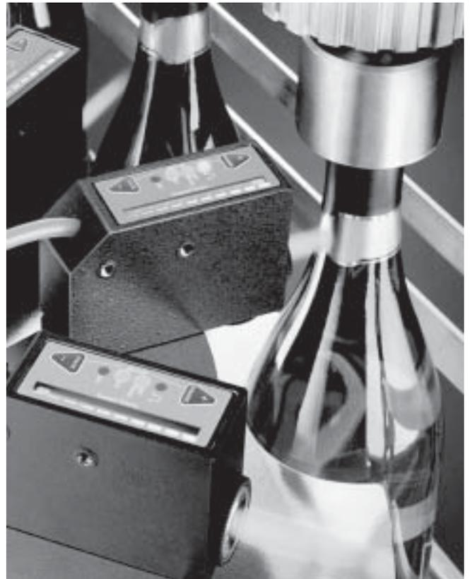
O R55 *Expert* oferece a confiabilidade do estado sólido, sem necessitar de manutenção, para todos os contrastes de cores encontrados em produtos comuns e aplicações de registro de material. A resposta rápida de leitura de 50 µs produz excelente repetição de registro, mesmo em aplicações de velocidades ultra-rápidas. Esta resposta rápida, combinada com a pequena imagem de leitura de 1,2 x 3,8 mm, permite que as marcas coloridas sejam pequenas e discretas.
