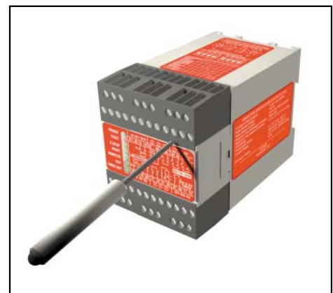
Fig.7 端子台の取り外し;小さなドライバーの先端をフロントカバー上下の各スロットに差し込み端子台を持ち上げる
