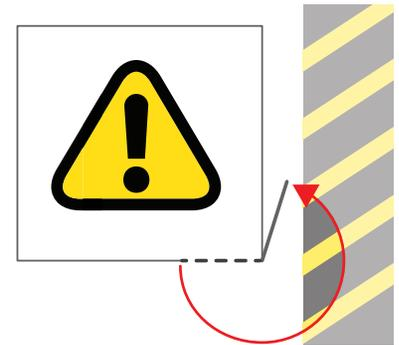
Un intervallo di rotazione di 270° assicura che le protezioni mobili possano essere aperte quando il punto pericoloso si trova in uno stato di sicurezza, senza interferire con gli spostamenti del personale o delle apparecchiature al di fuori dell'area protetta.
