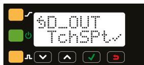
Con un singolo punto di commutazione, il sensore apprende la posizione dello sfondo ed è in grado di rilevare la posizione dell'oggetto.
