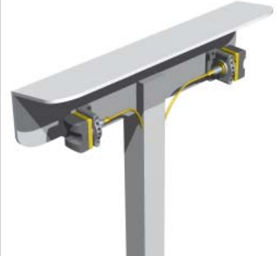
Figura 4. Installare i pulsanti a sfioramento STB in modo che siano protetti dalle attivazioni accidentali
