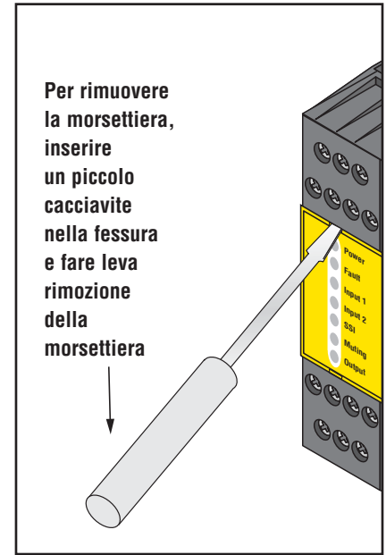
Figure 7. Rimuovere la morsettiera
