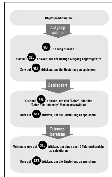
Abb. 2 Kurze Programmieranleitung des QC50 Sensors
