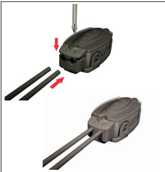
Abb. 6. Befestigung der Lichtwellenleiter in den Anschlussöffnungen des FI22FP
