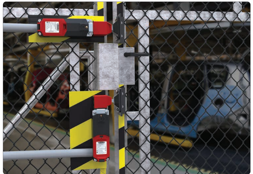
Interrupteurs de verrouillage sur un grand portail
