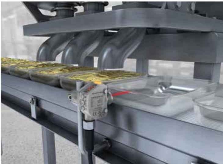
Con clasificación ambiental IP67, IP68 e IP69K, el Q4X COD resiste lavado en alta presión y temperatura que a menudo se encuentra en ambientes de alimentos, de bebidas y farmacéutico.
