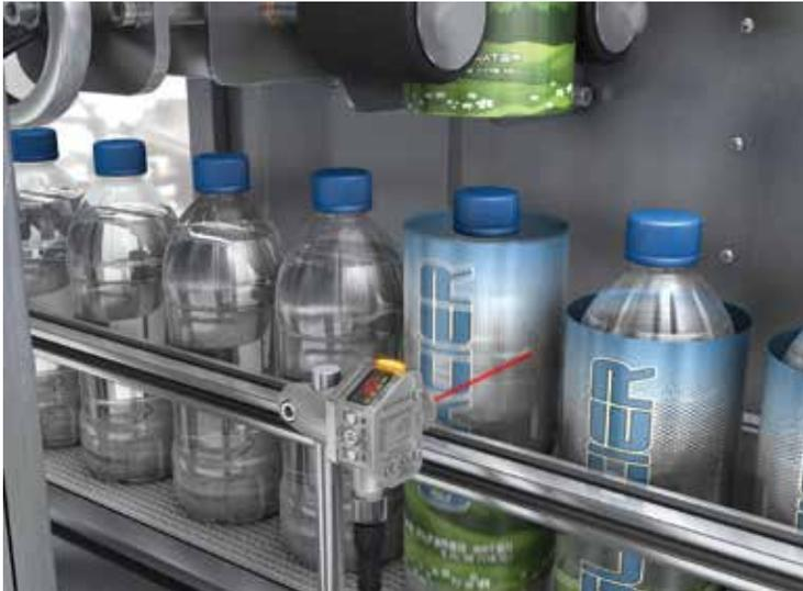
El sensor láser Q4X COD proporciona mayor precisión en detección de botellas, aun más confiable que las soluciones de sensores basados en LED. El sensor Q4X COD detecta las etiquetas termo-retráctiles obteniendo mayores velocidades y rendimientos en la línea de producción.
