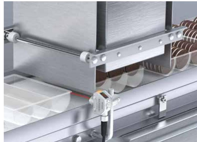
Un sólo sensor Q4X COD es capaz de detectar una amplia gama de objetos transparentes o translúcidos sin tener que volverle a enseñar, permitiendo cambios de línea más rápido y manteniendo la intervención del operador al mínimo. No requiere reflector.
