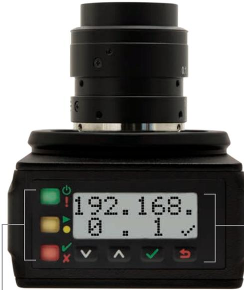
Helle LED-Anzeigen für die einfache Feststellung des Kamerastatus
