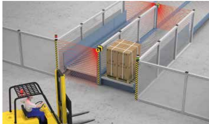
通过SX5软件配置,可在这个叉车通道应用中进行区域切换,以实现全面、右侧和左侧的安全保护。
