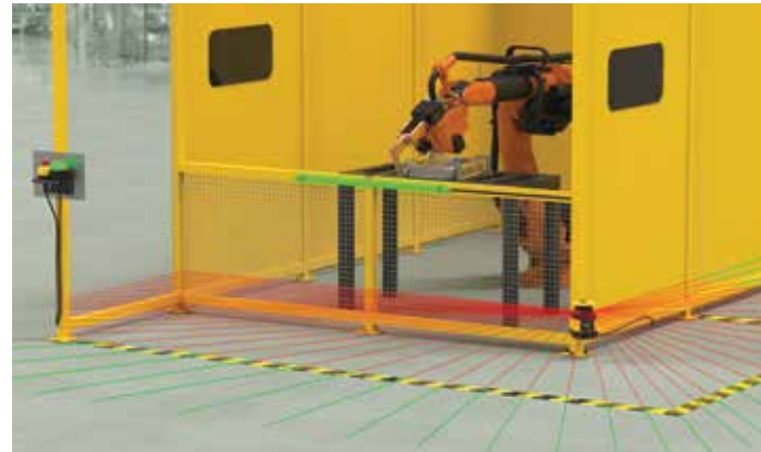
在软件界面中可以轻松创建定制的安全和警告区,从而保护大型、复杂和不规则形状的区域。
