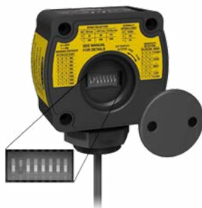
R-GAGE雷达传感器通过DIP开关轻松设置参数，无需连接PC调试
