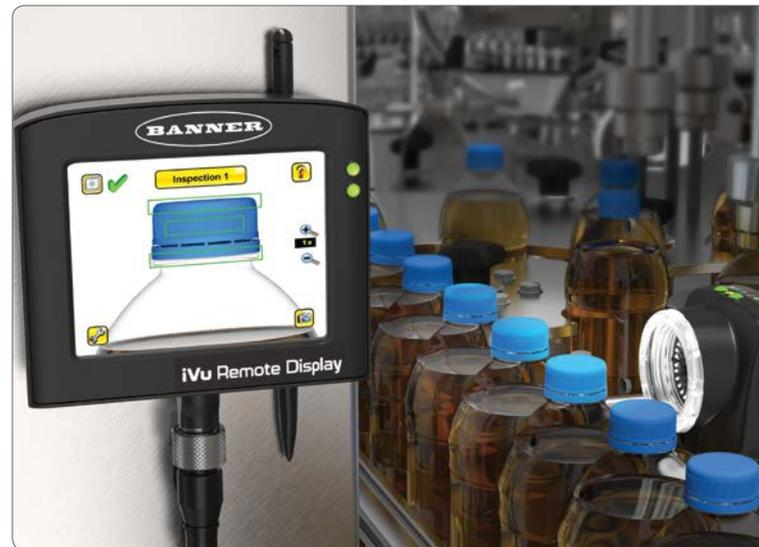
用于检测颜色、颜色变化的程度、特征点的尺寸、方向或位置
