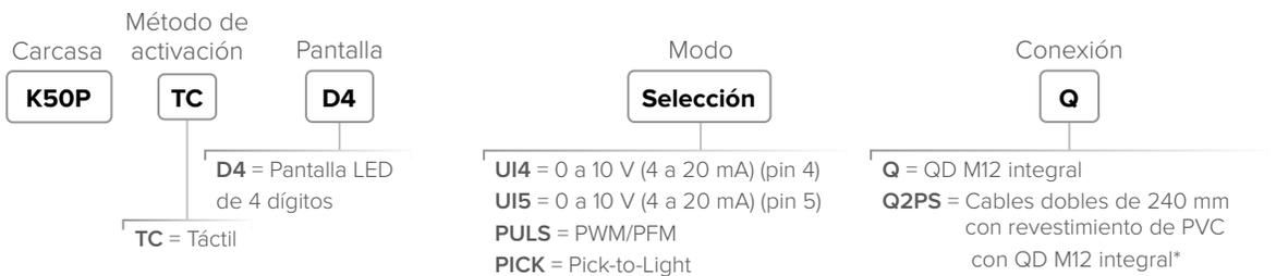
Los modelos de QD requieren de un cable conector de acoplamiento
