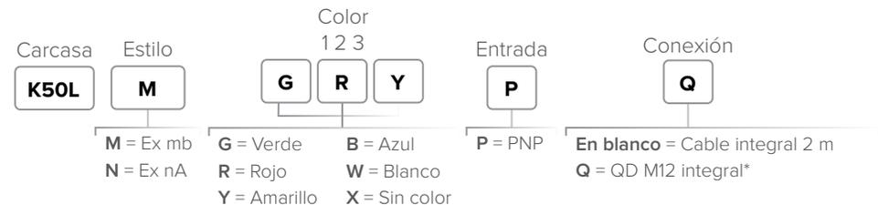
Los modelos de desconexión rápida requieren el cable conector correspondiente
