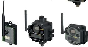
创建在大面积上分布I/O的点到多点网络。输入和输出类型包括离散型（干触点、PNP/NPN）、模拟型（0至10V直流、0至20mA）、温度型（热电偶和RTD）和脉冲计数器型号示例：DX80G2M6S-P2。
