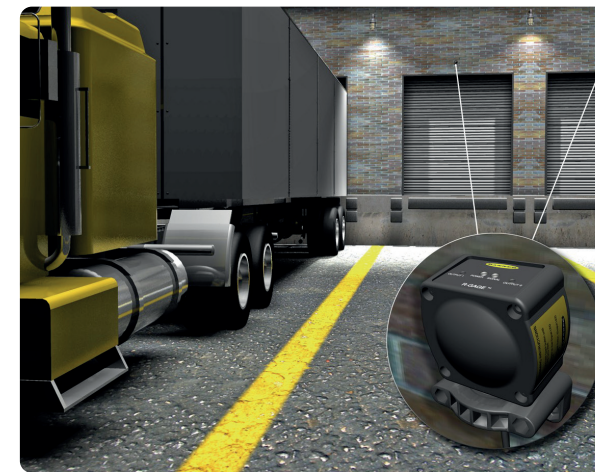
装货码头监测, 车辆计数
