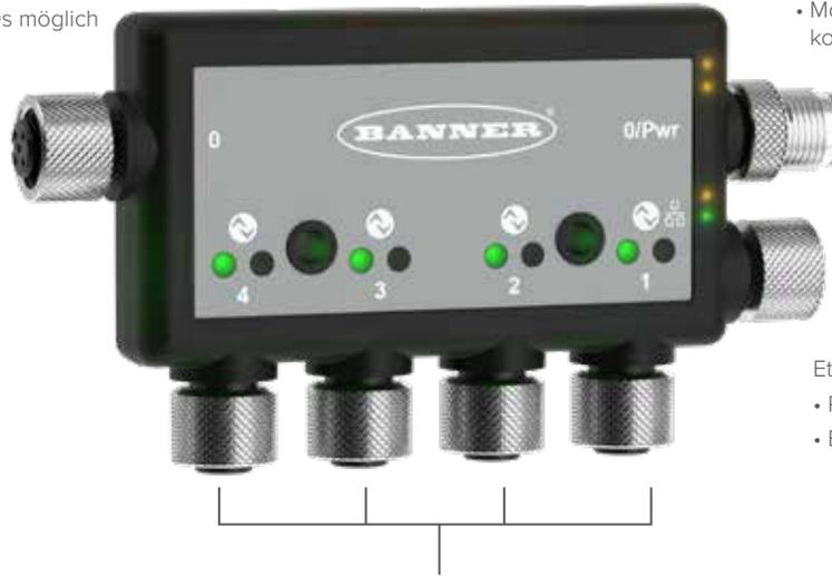
Port für Stromversorgung / Konfigurierbarer Modbus-Port
