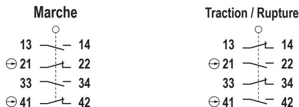
**Remarque:** Ce symbole pour un contact de sécurité à ouverture positive (IEC 60947-5-1) est utilisé dans le schéma de commutation pour identifier le point de la course de l'actionneur où le contact de sécurité normalement fermé est complètement ouvert.
