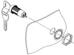
Permette di entrare in modalità *RUN* ed è inoltre usato per ripristinare il sistema *MINI-SCREEN* dopo un errore.
