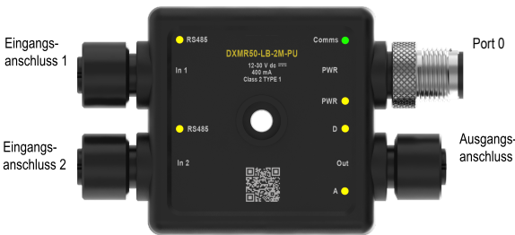
Eingangs- und Ausgangsanschlüsse des DXMR50-LB
