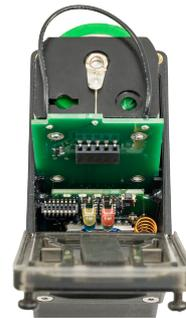
1. Afloje la placa de sujeción con un pequeño destornillador Phillips y levante la cubierta.
