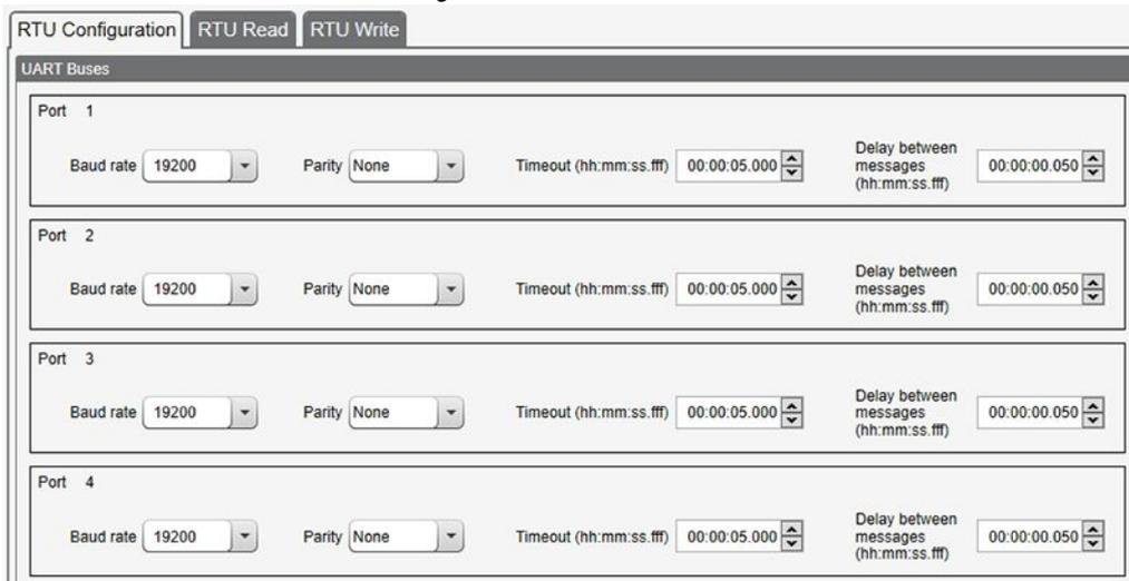
1. Definieren Sie die **Port**-Einstellungen so, dass sie mit den angeschlossenen Geräten kompatibel sind.
