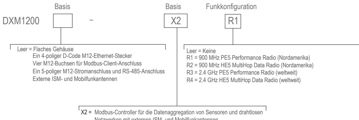
Sonderanfertigungen sind erhältlich und werden mit einer 6-stelligen Nummer hinter der Standardmodellnummer gekennzeichnet, z. B. DXM1200-X2R1-123456.
