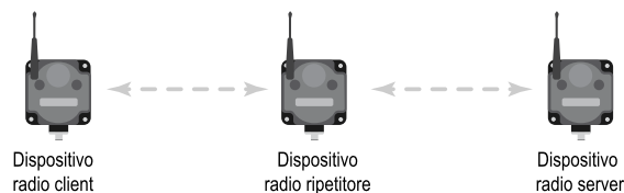
Rete punto-punto con ripetitore per applicazioni di sostituzione dei cavi
