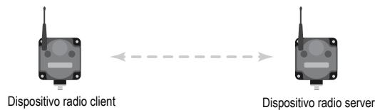
Rete punto a punto semplice per applicazioni di sostituzione dei cavi
