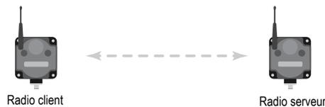
Dans cette application de remplacement de câble simple, le système radio sait que toutes les données provenant d'une extrémité doivent être transmises à l'autre extrémité. Il est ainsi en mesure de corriger automatiquement les problèmes de transmission et également d'offrir le meilleur débit. Il s'agit de la configuration la plus rapide.
