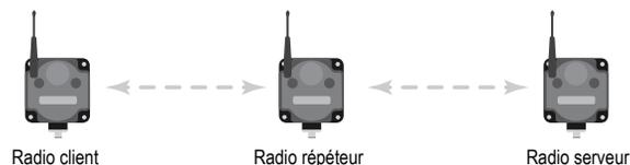
Dans cette application de remplacement de câble simple avec répéteur, le système radio sait que toutes les données provenant d'une extrémité doivent être transmises à l'autre extrémité. Dans cette application, aucun dispositif Ethernet n'est connecté au(x) répéteur(s). Le système corrige toujours les problèmes de transmission, mais la répétition du message est longue. Le retard du réseau est deux fois supérieur à celui d'un système sans répéteur.
