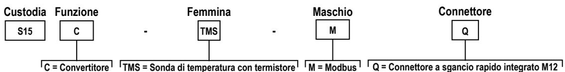
La dotazione del convertitore include i seguenti accessori: termistore con cavo da 2,9 m e connettore a sgancio rapido M12.
