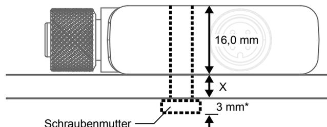
$$\text{Schraubenlänge} = 16,0 \text{ mm} + „X“ \text{ mm} + 3 \text{ mm}$$
