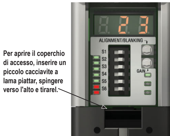
Figura 19. Tutti i DIP switch sono mostrati nella posizione predefinita (ON)
