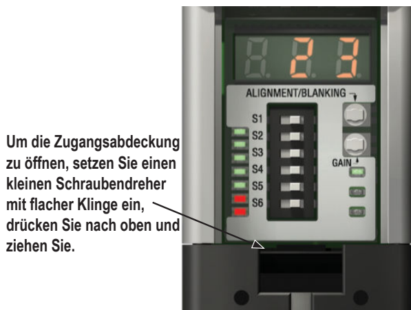
Abbildung 19. Alle DIP-Schalter sind in der (standardmäßigen) eingeschalteten Position abgebildet.
