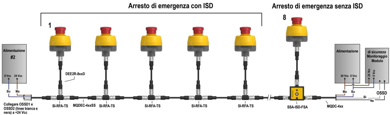
Figura 8. Lunghezza massima totale del cavo per una singola alimentazione
