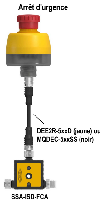
Illustration 2. Câblage du SSA-ISD Connect à un bouton d'arrêt d'urgence SSA-EB1P-02ECQ5A avec un câble MQDEC-5xxSS
