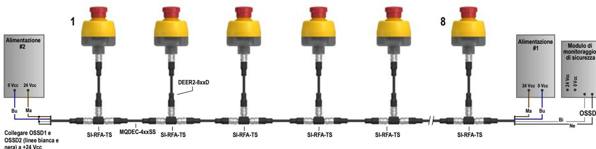
Figura 11. Lunghezza massima totale del cavo per una singola alimentazione
