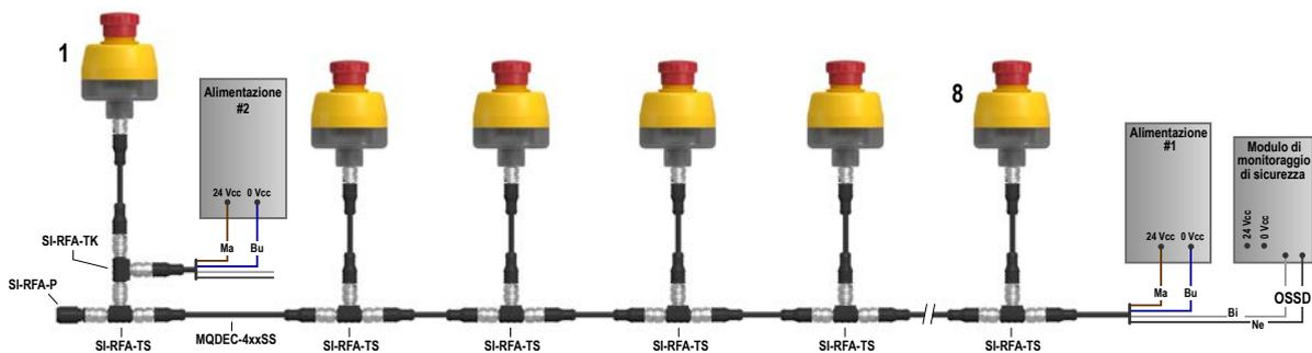
Figura 10. Opzione 2: sostituire il terminatore con un alimentatore. I fili OSSD1 e OSSD2 all'alimentazione n. 2 devono essere collegati a +24 Vcc. Se disponibile, impostare gli alimentatori per l'uscita in parallelo.
