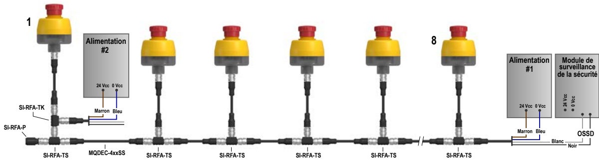
Illustration 10. Option 2 : remplacer la fiche de terminaison par une alimentation électrique. Les fils OSSD1 et OSSD2 de l'alimentation n° 2 doivent être alimentés en +24 Vcc. Si possible, réglez les alimentations pour une sortie en parallèle.
