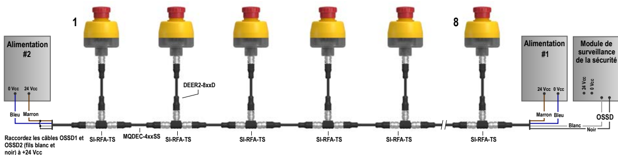
Illustration 10. Option 2 : remplacer la fiche de terminaison par une alimentation électrique. Les fils OSSD1 et OSSD2 de l'alimentation n° 2 doivent être alimentés en +24 Vcc. Si possible, réglez les alimentations pour une sortie en parallèle.
