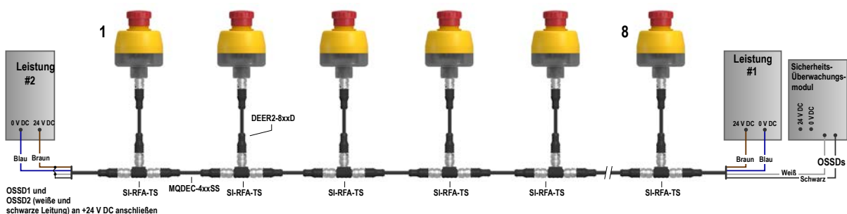
Abbildung 10. Möglichkeit 2: Ersetzen Sie den Abschlusswiderstand durch eine Stromversorgung. Die OSSD1- und OSSD2-Leiter an der Stromversorgung Nr. 2 müssen an +24 V DC angeschlossen werden. Falls verfügbar, stellen Sie die Stromversorgungen für parallel geschaltete Ausgänge ein.
