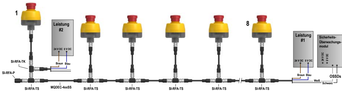
Abbildung 10. Möglichkeit 2: Ersetzen Sie den Abschlusswiderstand durch eine Stromversorgung. Die OSSD1- und OSSD2-Leiter an der Stromversorgung Nr. 2 müssen an +24 V DC angeschlossen werden. Falls verfügbar, stellen Sie die Stromversorgungen für parallel geschaltete Ausgänge ein.
