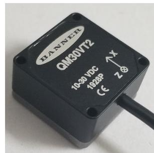
3. Avvitare il sensore alla staffa con le viti fornite mediante una chiave a brugola esagonale da 2 mm. La coppia massima per le viti a brugola è 0,5 N-m. Non stringere eccessivamente.
