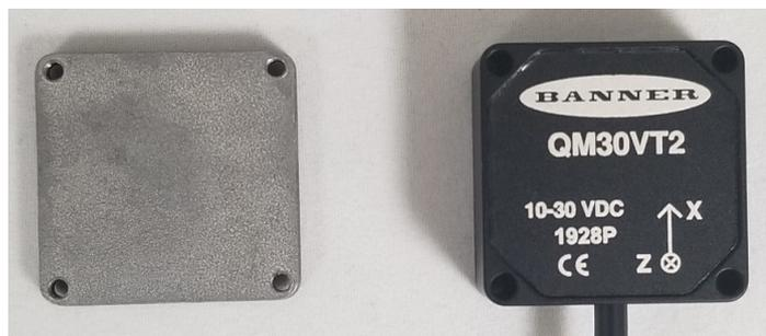
3. Posizionare il sensore sulla parte superiore della staffa, allineando i quattro fori agli angoli.
