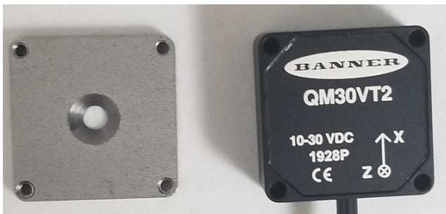
Figura 3. QM30VT2 montato sulla staffa BWA-QM30-FTAL
