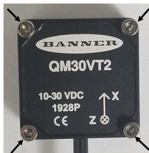
Illustration 4. Capteur QM30VT2 vissé sur l'équerre BWA-QM30-FTAL
