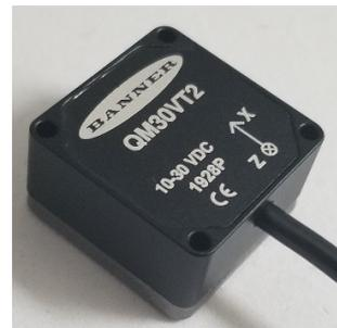
3. Schrauben Sie den Sensor mit den mitgelieferten Schrauben und einem 2 mm Inbusschlüssel am Montagewinkel fest. Das maximale Drehmoment für Innensechskantschrauben beträgt 0,5 Nm. Nicht zu fest anziehen.
