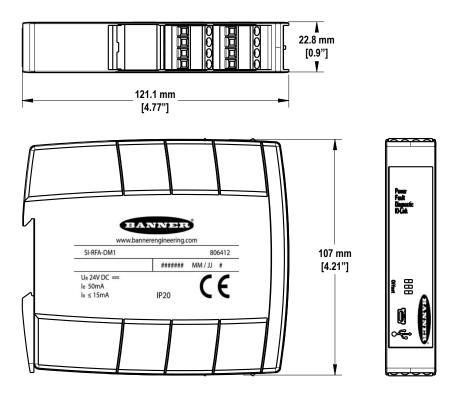
Figure 5. SI-RF-DM1 Module
