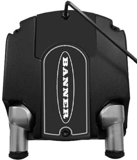
3. Avec la clé hexagonale de 2,5 mm, desserrez les deux vis du dispositif de mémoire amovible.
