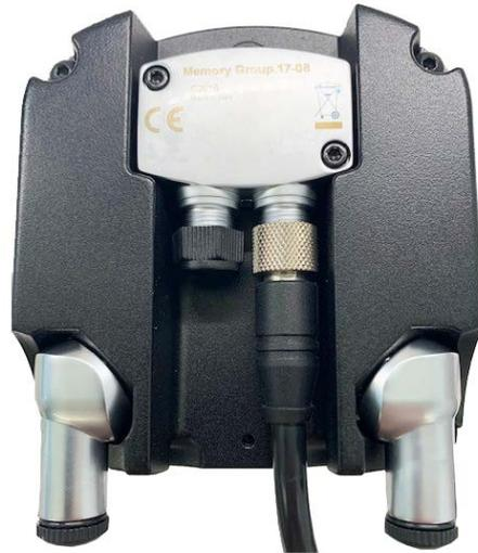
7. Remplacez le couvercle de protection et serrez les deux vis pour le maintenir en place (couple de serrage 0,5 Nm).
