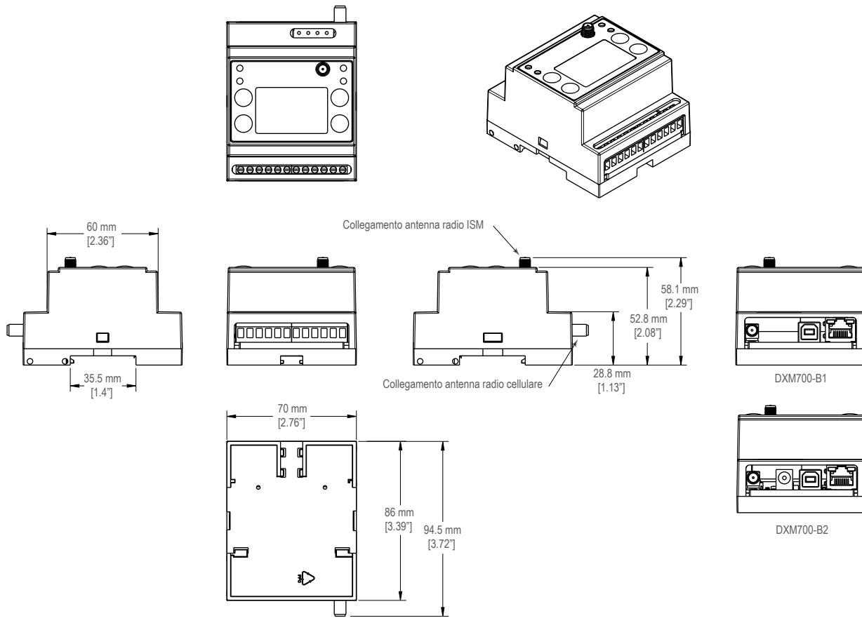
Se non diversamente specificato, tutte le misure indicate sono in millimetri (pollici). Le misure fornite sono soggette a modifiche.
