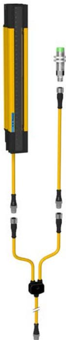
Con ricevitori standard (SLLR...P8), utilizzare con un cavo splitter CSB-M128..M1281 e cavi con connettore a due estremità opzionali DEE2R-8..D. Quando si effettua il collegamento all'interfaccia della macchina, utilizzare solo i modelli EZ-LIGHT con il suffisso "8PQ8". Per maggiori informazioni, vedere la scheda tecnica codice 121901.
